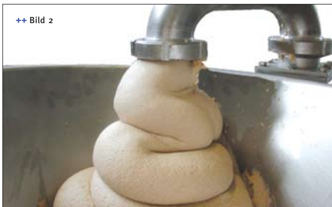
++ Bild 2 Teigaustritt aus dem Inline-Laminator in den Trichter eines Teigteilers
