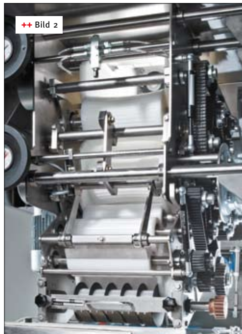
++ Bild 2 Der Walzenstuhl der Quadro RelaxS für das schonende Bearbeiten des Teiges
