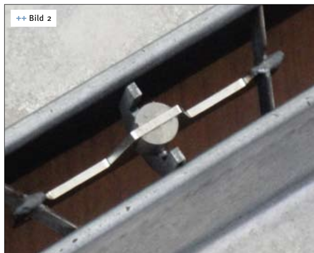
++ Bild 2 Formenverbände und Deckel mit Magnetelementen
