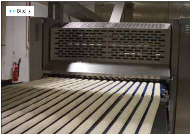
++ Bild 5 Die einzelnen, gefüllten Teigstreifen werden gespreizt, anschließend geschnitten und gelangen in den Tunnelgärschrank
