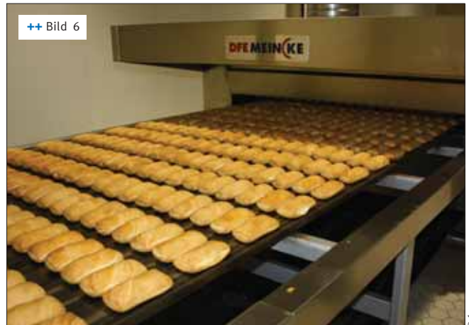
++ Bild 6 Die Teigtaschen verlassen nach 20 Min. den Stahlband-Tunnelofen
