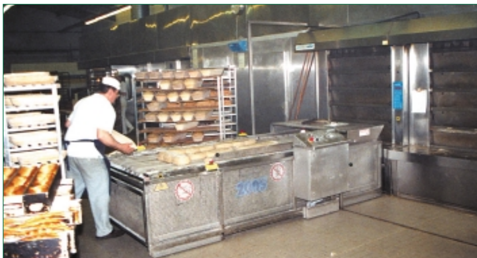
Die Brote werden manuell auf das Band des Scherentischs aufgelegt.
