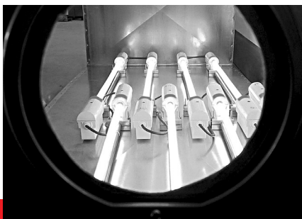
Beispielhafte Innenansicht einer UV-C-Brennkammer
