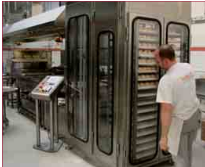
Die Teiglinge gelangen automatisch vom Stikken in das Siedebad, werden gewendet, abgenommen und gefüllt. Nur eine Person ist für den gesamten Prozess notwendig.
