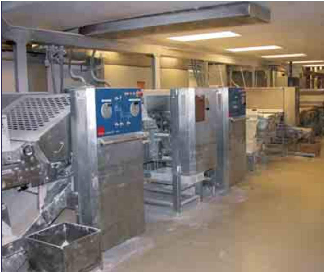
Die zentrale Aufarbeitung läuft hauptsächlich über zwei Fritsch-Laminator-Linien.
