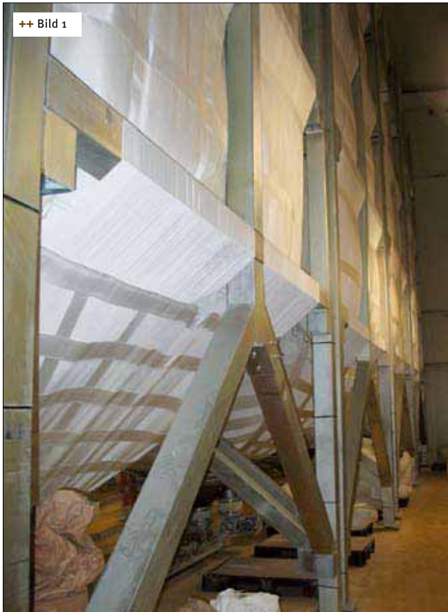
++ Bild 1 Moderne Textilsilos versorgen die Produktion mit den verschiedenen Mehlen und Vormischungen
