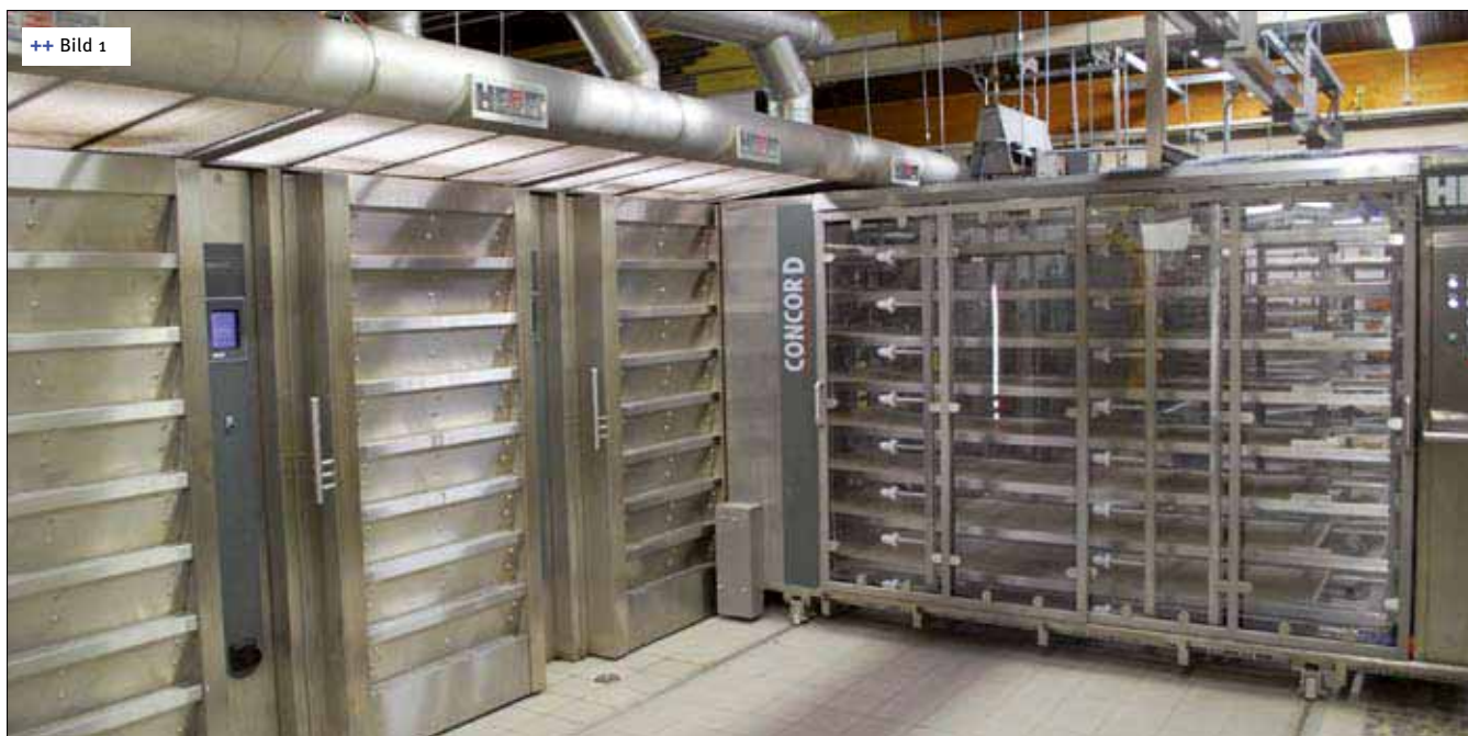
++ Bild 1 Ein individuelles Klappensystem pro Herdfläche verschließt den Ofen
