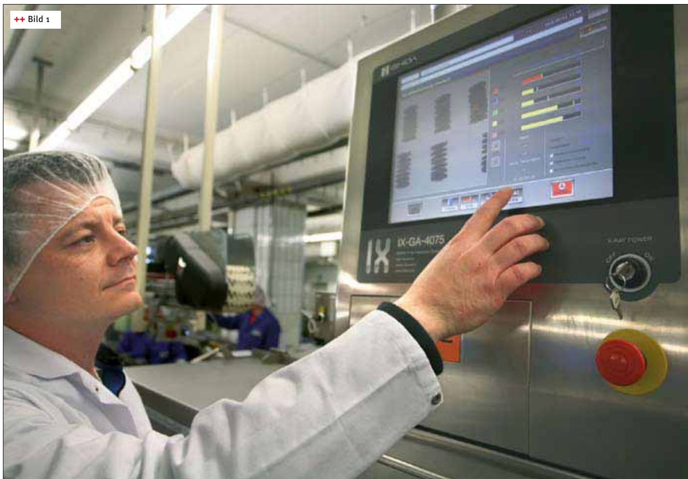
++ Bild 1 Die Bedienung der Röntgenprüfsysteme erfolgt am Touchscreen
