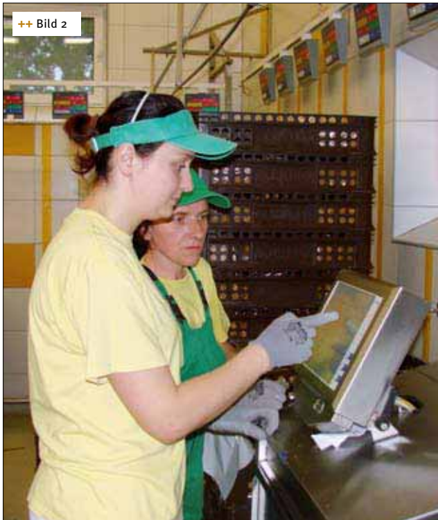
++ Bild 2 Über einen Touch-Industrie-PC wählt der Versandmitarbeiter die Ware bzw. den Kunden oder die Tour aus
