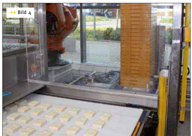
++ Bild 4 ... wo der Roboter die gefüllten Dielen dann stapelt
