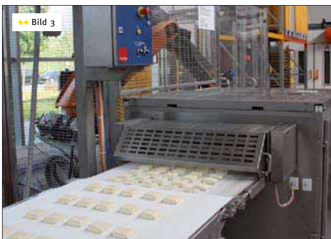
++ Bild 3 Die Teiglinge laufen von der Anlage zur Übergabe...
