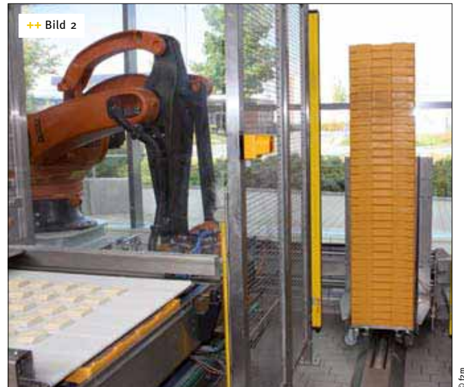
++ Bild 2 Der Roboter stapelt zunächst zwei Dielen übereinander und setzt sie dann auf einen Sammelstapel zur Übergabe in Gare über Kühlung
