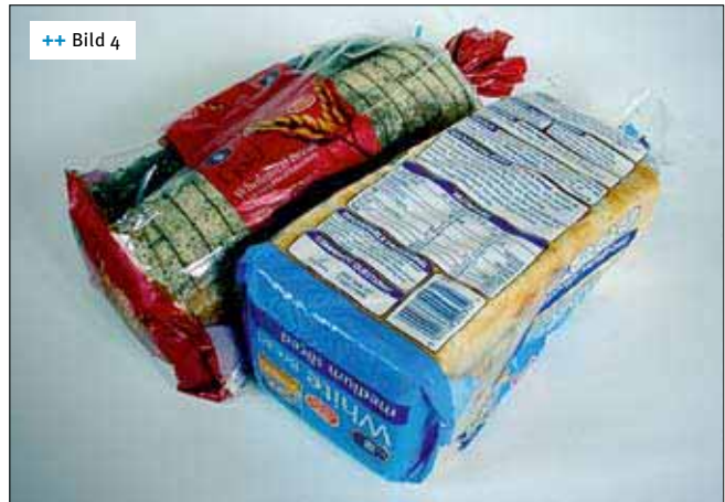
++ Bild 4 Brotverpackungen, die sich dank AddiFlex rückstandsfrei zu Wasser, Kohlendioxid und Biomasse abbauen
