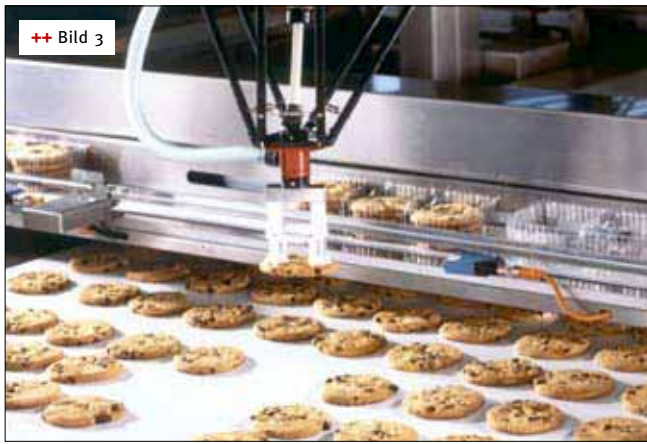
++ Bild 3 Roboter beim Verpacken von Keksen
