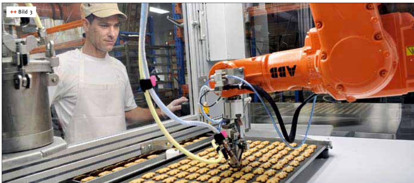
++ Bild 3 Schnell, flexibel und mit höchster Präzision setzt der IRB 140 täglich über 60.000 Tupfen
