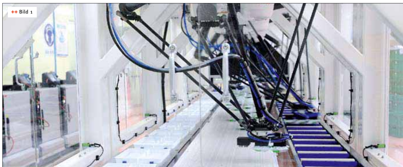
++ Bild 1 Bis zu 560 Pick&Place-Operationen pro Minute leistet jede der beiden Verpackungslinien mit ihren FlexPickern IRB 360
