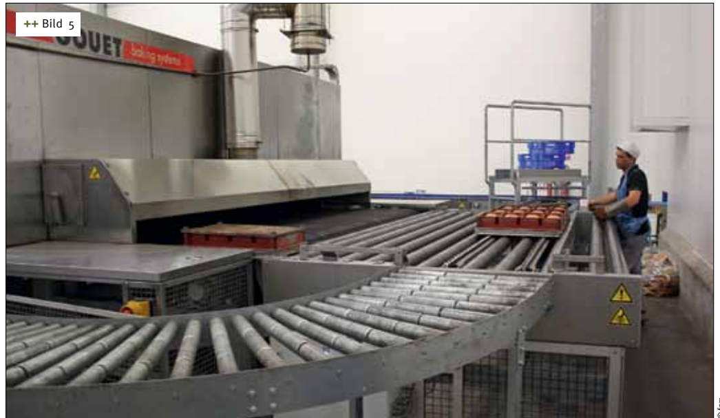
++ Bild 5 Nach dem Backen nimmt ein Mitarbeiter die Deckel von den Formen. Der Weitertransport erfolgt automatisch
