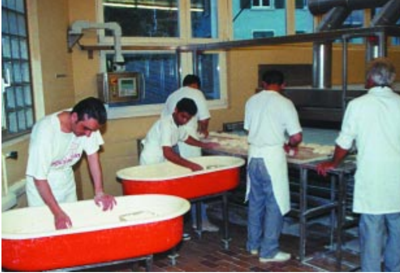
Aus Wannen wird der Teig nach der Schalengare von Hand ausgehoben und auf das Beladeband des Ofens aufgesetzt.
