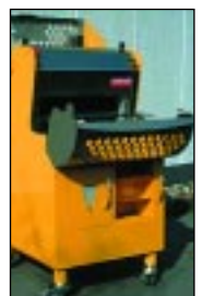
Die Sigma SB von Wabäma unterscheidet sich vor allem durch die großzügig dimensionierten Abdeckhauben am Einlass und Auslauf des Brots.
