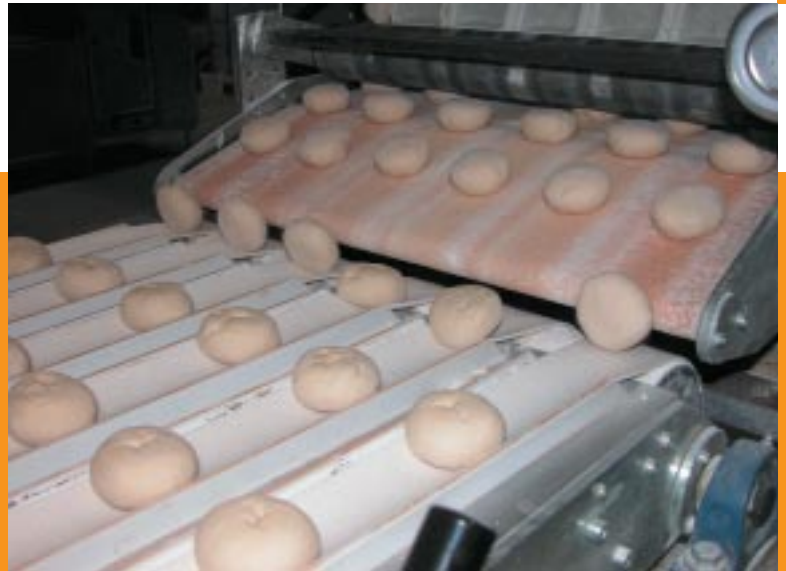
Pro Stunde verlassen rund 15.000 ca. 68 g schwere Teiglinge die Kopfmaschine.
