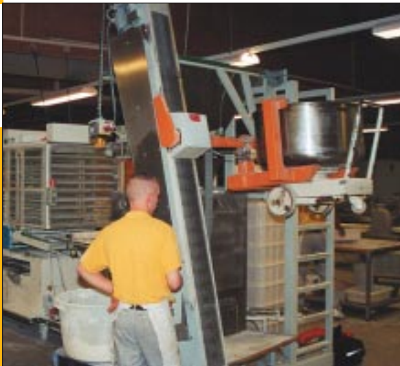
Der Teig wird mit einem Hebekipper in den Vorportionierer gefördert, dieser sichert einen kontinuierlichen Betrieb der Anlage.
