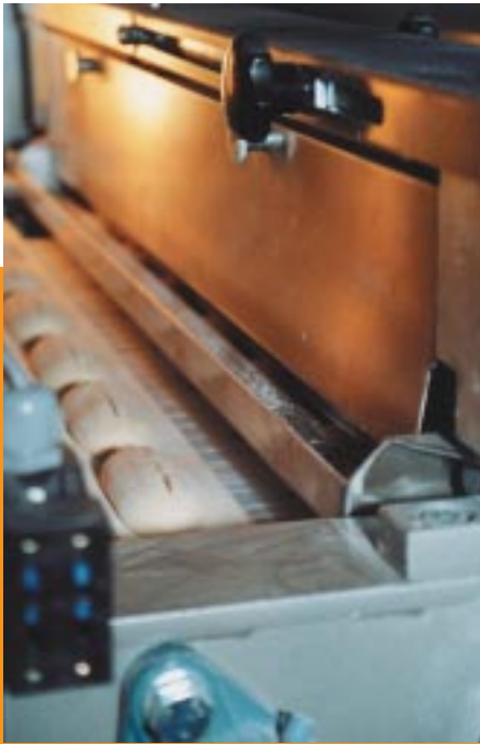
Beindruckend ist der absolut saubere Schnitt in den Teiglingen, die anschließend mit der Schnittseite nach unten gekippt werden.
