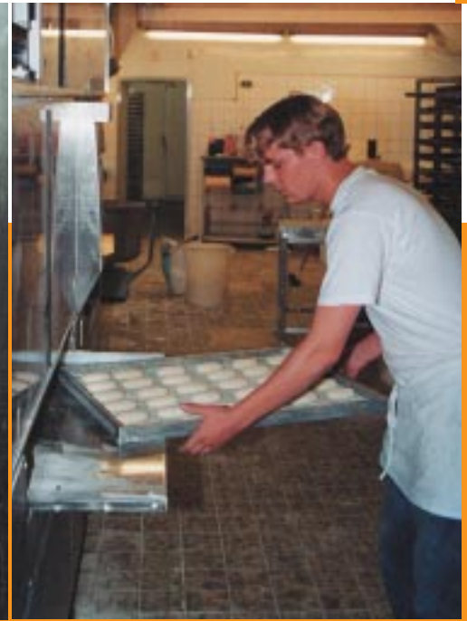
Die Abnahme erfolgt über ein Abziehband, dabei liegen die Teiglinge exakt auf den Gärgutträgern. Ein manuelles Nachrichten ist nicht notwendig.
