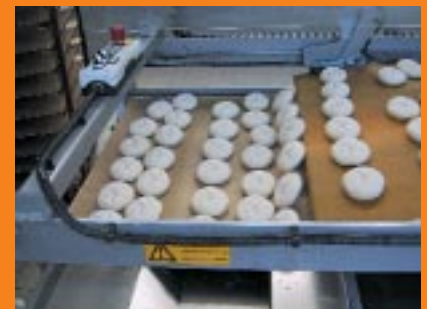
Die Absetzung in Aktion. Die abgeflachte Nase des Abziehbands ist deutlich zu sehen.
