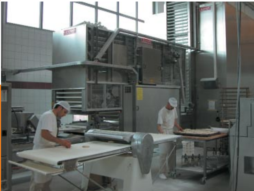
Die gesamte Anlage wird optisch durch den Endgärschrank mit 4.500 Gehängen dominiert.
