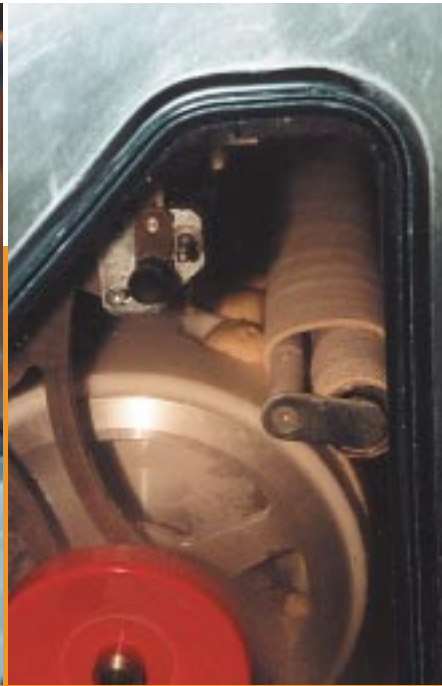
Nach dem Teilen fallen die Teiglinge in die Wirkwaben der Trommel. Das Zusammenspiel der oszillierenden Wabentrommel mit dem Wirkband garantiert ein gutes Wirkergebnis.
