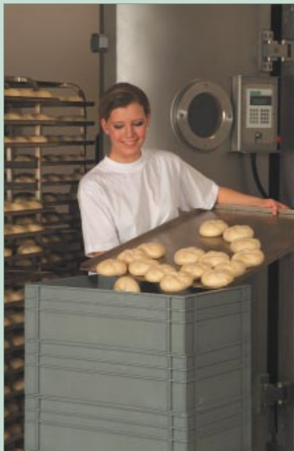
Durch die Vakuumkühlung bekommen selbst halbgebackene Brötchen so viel Stabilität, dass sie einfach abgeschüttet werden können.
