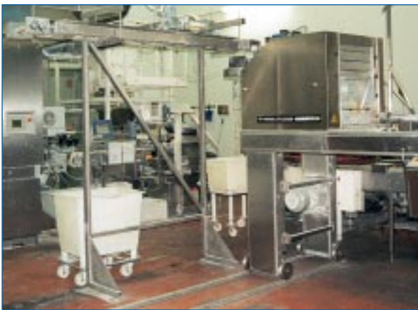
Die Teigaufarbeitung übernimmt, wie in vielen Brioche-Linien in Frankreich, WP-Anlagentechnik.
