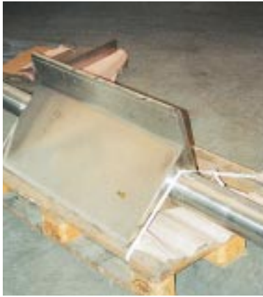
Dreiflügelige Knetwerkzeug des Verymix.
