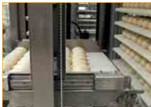
Ein kleiner Lader nimmt automatisch die reifen Teiglinge aus dem Stikkenwagen und führt sie auf ein Pufferband, von dort werden sie reihenweise in die Fettpfanne getaktet.
