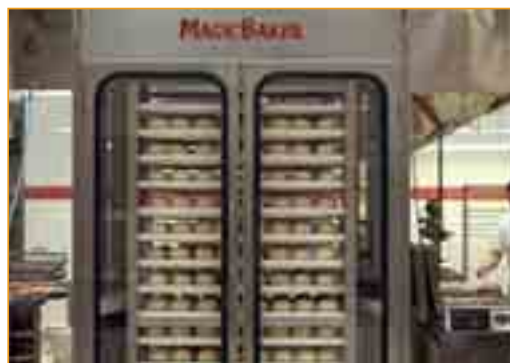
Der Stikkenwagen mit den reifen Teiglingen wird in einem Andockschränk bis zur automatischen Entnahme der Teiglinge gefahren. Die Teiglinge können dort absteifen.
