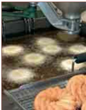
Mit einer manuellen Dressiermaschine wurde die Spritzkuchenmasse dosiert.
