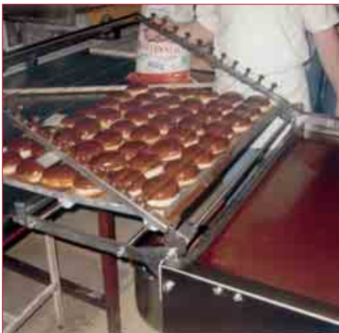
Ein Schokoladentauchbad für Berliner. Das Gitter hält die Berliner beim Eintauchen, so dass die Tauchhöhe reguliert werden kann.
