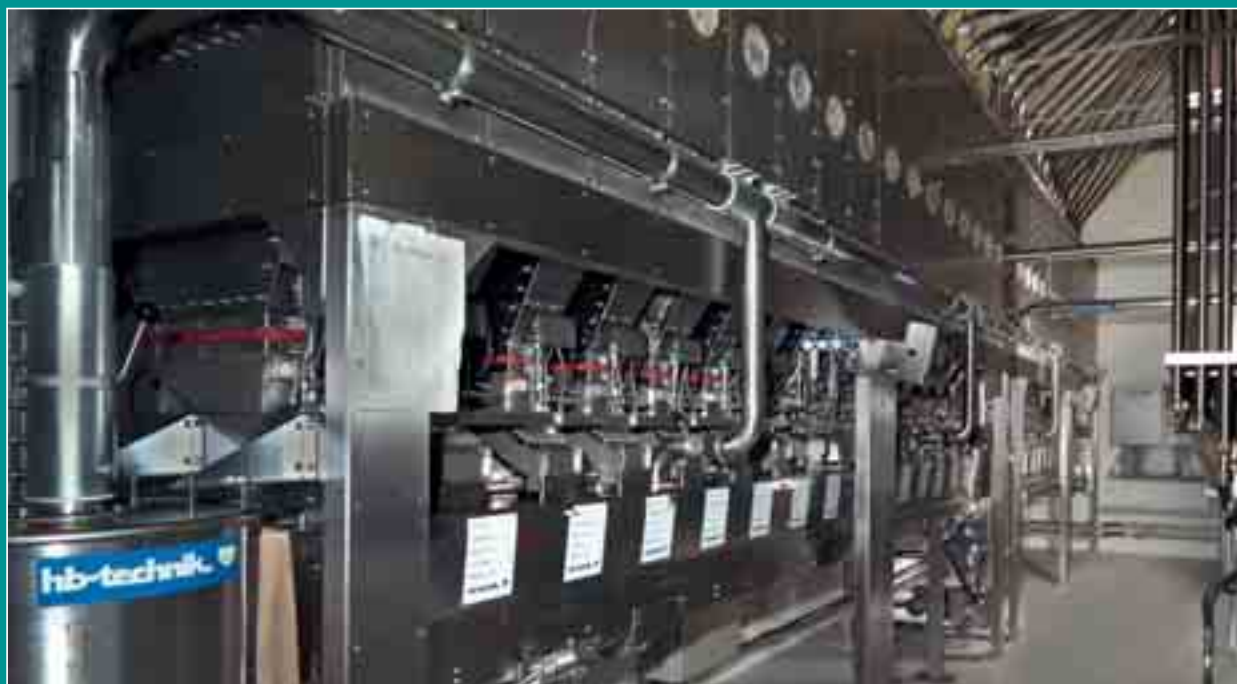
Gerade bei der Kleinkomponentenverwiegung gehen immer mehr auf Nummer sicher, vollautomatisch soll Fehler vermeiden.
