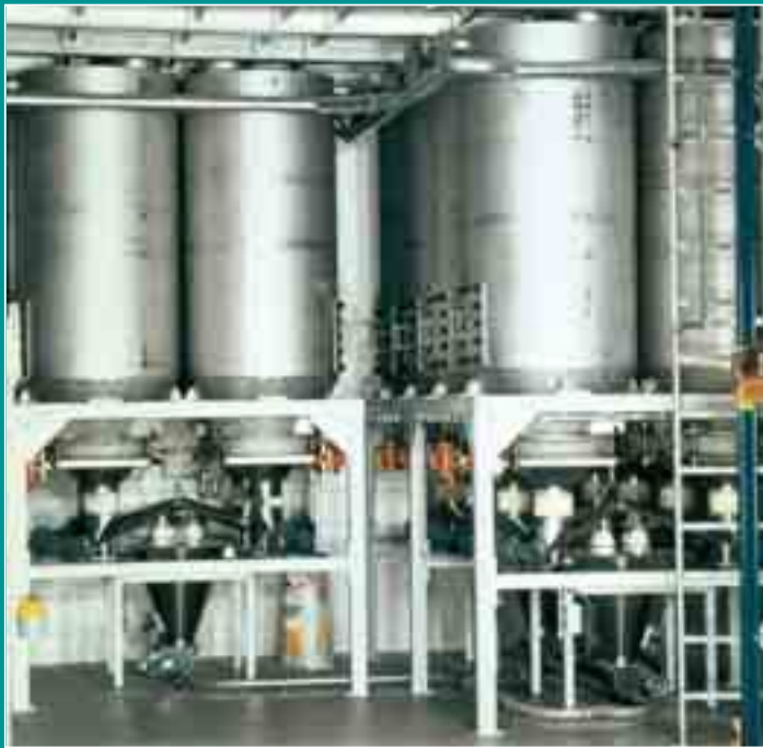
Die Befüllung der Kleinkomponentensilos kann, wie bei AT, auch über Big-Bags erfolgen.
