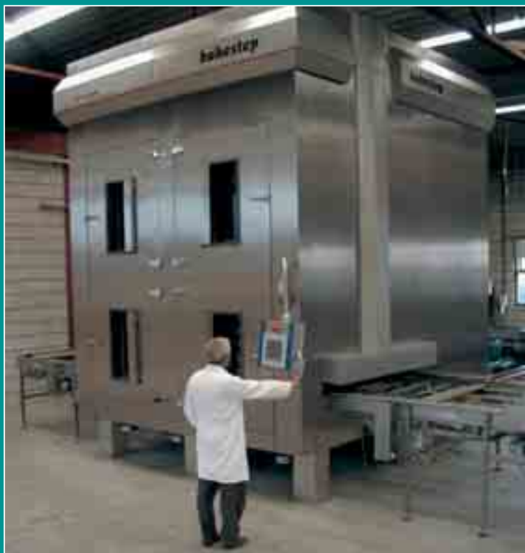
Der Vertikalofen bei der Bäckerei „de Bakkerie“ in Bunschoten: 46 m 2 Backfläche auf 18 Etagen verteilt und einer Stellfläche von 15 m 2 .
