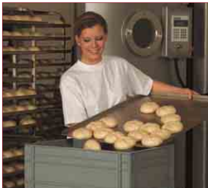
Durch die Vakuumkühlung bekommen selbst halbgebackene Brötchen so viel Stabilität, dass sie einfach vom Blech abgeschüttelt werden können.
