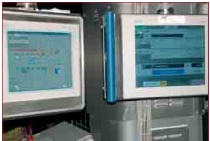
Der linke Touchscreen gibt Auskunft über die Teigbereitung, der rechte über die Rohstoffverwiegung.
