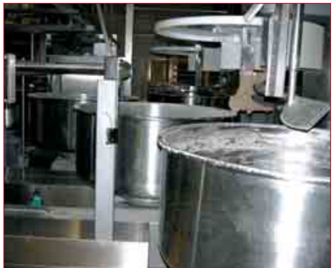
Die Kessel wechseln die Standplätze. Der fertig geknetete Teig wandert auf eine der Ruhestationen.
