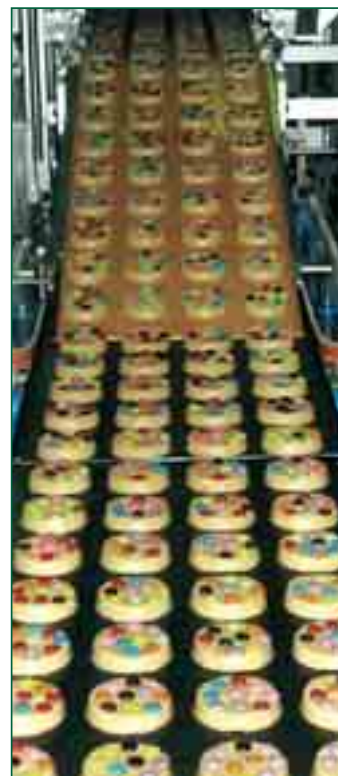
Abmarsch in den Ofen – die dekorierten Kekse werden entweder direkt auf das Ofenband abgegeben oder auf Backbleche abgelegt.
