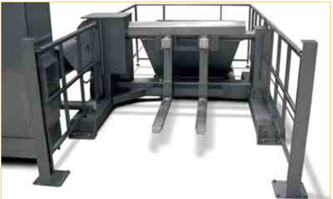
Ein Tropfblech schwenkt unter das Rührwerkzeug, sowie es aus dem Kessel abgesenkt wird.
