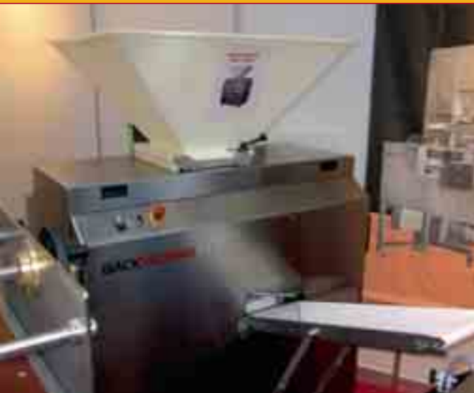
Bei der neuen Brotteigteilmaschine erfolgt der Produktaustrag seitlich über ein Förderband, das die Teigstücke an eine Wirkmaschine transportiert.
