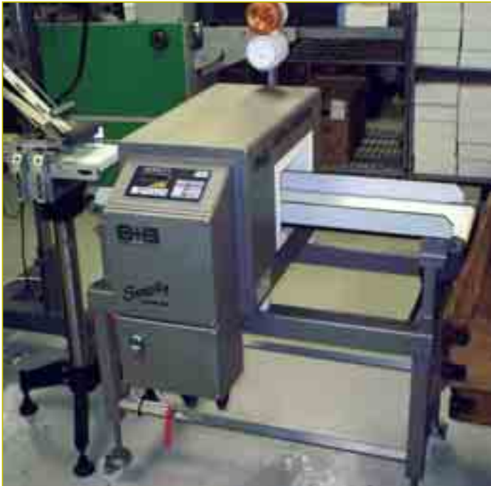
Der Metallseparator CONSENSE-D von S+S im Einsatz bei der Großbäckerei „Devonvale Bakery“ in England.
