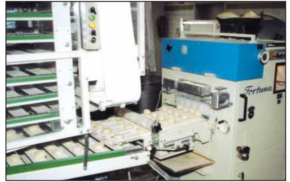
Die Kopfmaschine ist drehbar, so lassen sich auch runde Teiglinge, beispielsweise für Krapfen, abnehmen.
