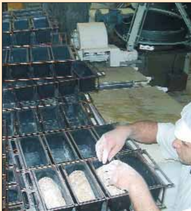
Ein Mitarbeiter bestückt die Formen per Hand und lädt die Verbände in einen Stikken.
