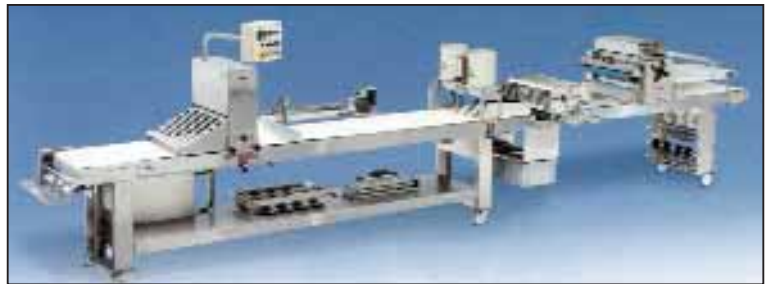
Basisanlage für eine rationelle Feingebäckherstellung: die Jumbolino von Seewer/Rondo Doge.
