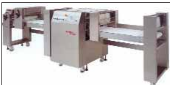
Satellitenkopf mit Kalibriereinheit: So lassen sich Endlos-Teigbänder rationell und ohne großen Materialverlust auf die Linie bringen.
