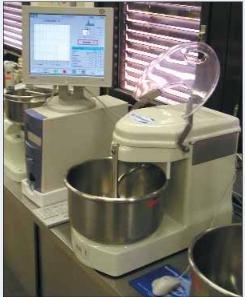
Kneten in Startposition. Auf dem Bildschirm sind alle Prozessparameter mit einem Blick ablesbar.
