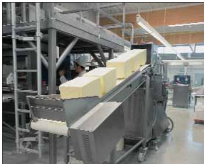
Bei Wolf Butterback wird ausschließlich Markenbutter in Blöcken über Fettpressen in die Teigbänder eingebracht.
