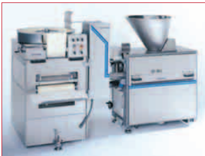
Sonderlösung: Die Kombination eines Teigteilers von Rheon mit einer Wirkstation von Eberhardt.
