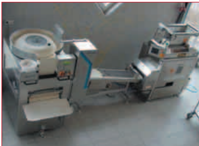
Sonderlösung: Die Kombination eines Teigteilers von Rheon mit einer Wirkstation von Eberhardt.
