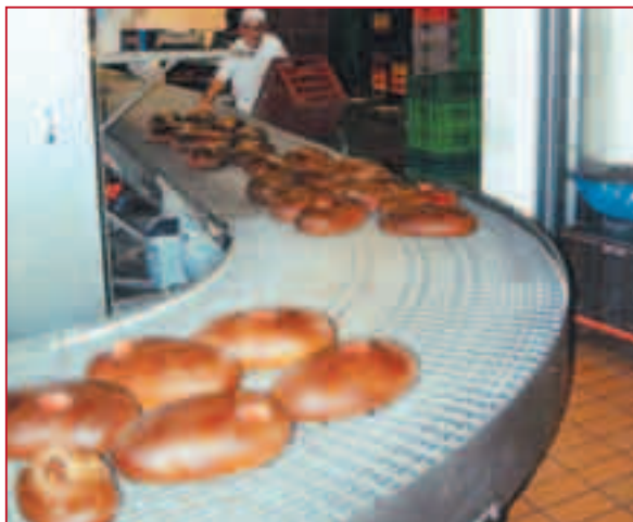
Das Zentrum der Bäckerei, ein sechsherdiger Megador mit 108 m 2 Backfläche. Vom Auslauf gehen die Brote automatisch über ein Zuführband in die Expedition.
