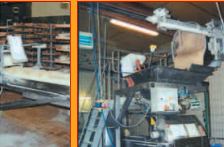
Hebekipper und Teigteiler TM 700, Rund- und Langwirker von Kemper verarbeiten das gesamte Brotsortiment und stehen damit für 75% des Umsatzes.
