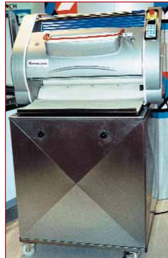
Der neue Baguetteroller von Bongard verarbeitet Teigstücke von bis zu 1.500 g Stückgewicht.
