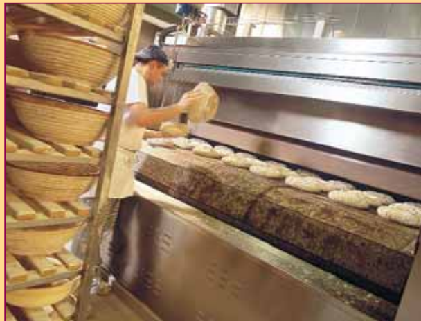
Die Belegung des Steinplattenofens erfolgt manuell oder mit Querabziehern.
