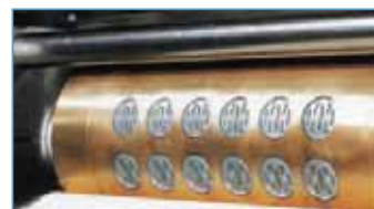
Eine Option ist die Auflage von Schwebedekoren mit einer in die Linie integrierten Gebäckformmaschine.
