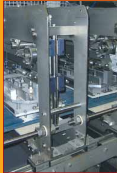
Die Guillotine mit vertikaler und horizontaler Servosteuerung. Der Rahmen fängt die Kraft auf, so dass weder der Tisch noch die umliegenden Aggregate gestört werden.
