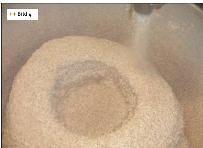
++ Bild 4 Austritt des „Teignebels“ aus dem Rapidojet (hier mit groben Rezepturbestandteilen, in drehenden Knetkessel dosiert)
